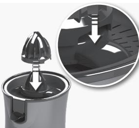
**2. Ak je ovocie príliš veľké, použite veľký kužel.** Umiestnite ho na malý kužel, pričom dbajte na to, aby drážky na veľkom kuželi zapadli do výstupkov malého kužeľa.
